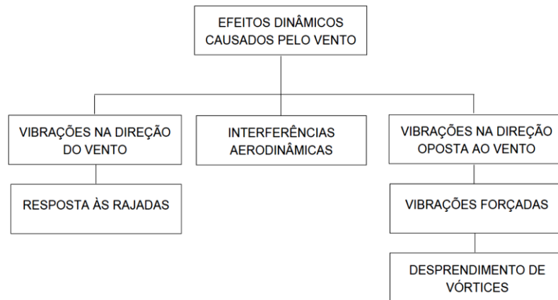
Figura 3.4 - Análise dos efeitos dinâmicos do vento (adaptado de Hirsch, G. e Bachman, H.,1991)
