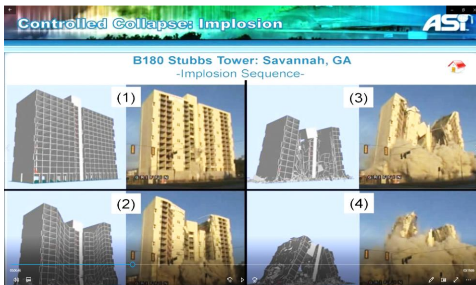
Figura 7.6 - Análise da sequência de colapso pós-implosão (Khalil, A. A., WDS, 2013)
