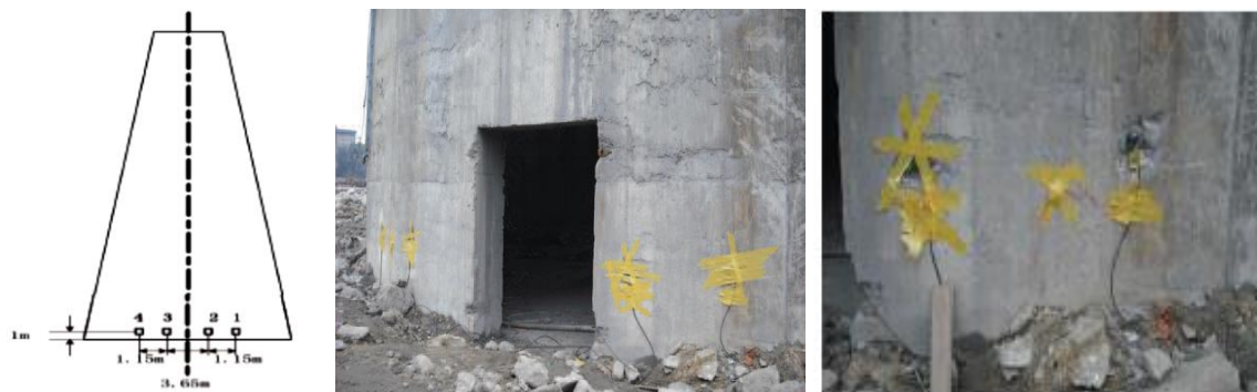
Figura 6.4 - Disposição dos pontos de medição de extensão da armadura (Chen, D. et al., 2014)
